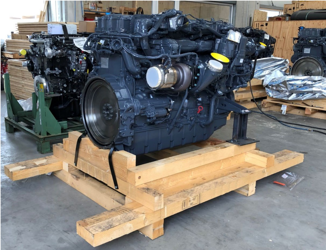
Abbildung 6: Motor auf Holzgestellt zur Verpackung mit Korrosionsschutz in Holzkiste
