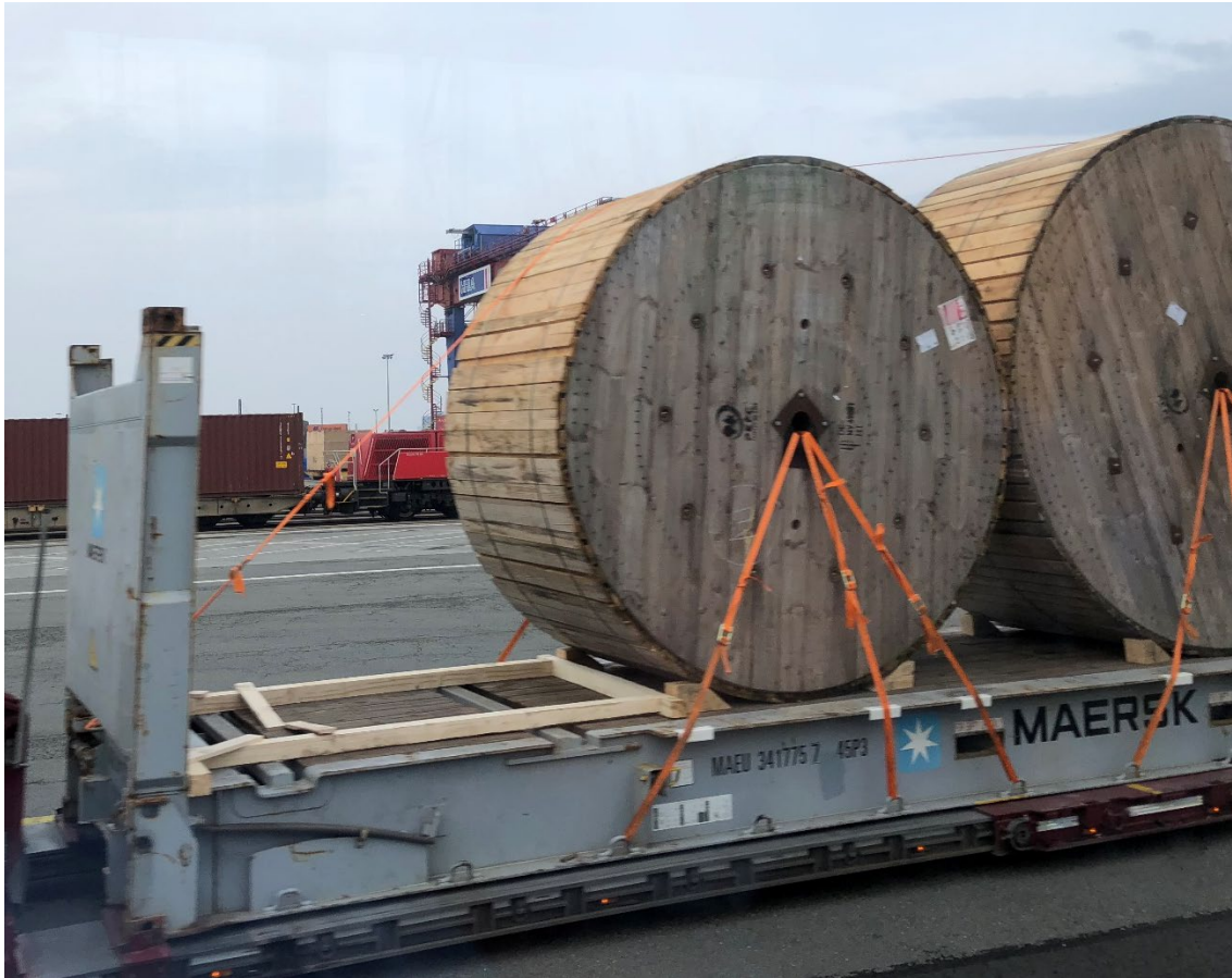
Abbildung 2: Kabel-/Seiltrommeln fixiert mit Keilen auf einem Open-Flat-Container
